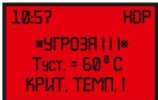
При превышении температуры выше 85 - 90°C, зафиксированной аварийным термостатом, независимо от основного датчика температуры котла, происходит дополнительная информирование о высокой температуре и включение сообщения УГРОЗА. Защита включается независимо от работы других защит и имеет максимальный приоритет
