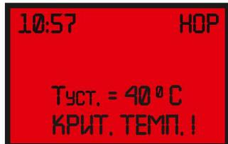
включается индикатор и звуковая сигнализация тревоги. Во время, когда работает сигнализация (температура выше, чем 90°C) шнек и вентилятор выключаются безоговорочно. Циркуляционные насосы включаются в аварийном режиме, чтобы охлаждать систему отопления. Эта тревога работает до того пока температура не упадет ниже 89°C.
