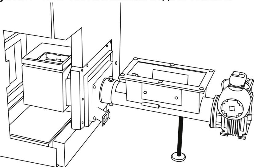
**Рисунок 3 – Место установки механизма подачи топлива**
