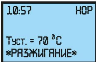
Рисунок 12 – Вид панели управления в режиме РАЗЖИГАНИЕ
