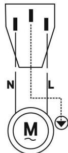
**ВНИМАНИЕ!** Перед тем как подключить насос, вентилятор и механизм подачи отключите блок управления от напряжения полностью. Вилка должна
